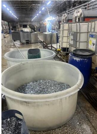
Mit dieser Apparatur und den Steinen im Trog entstehen „stone-washed jeans“.
